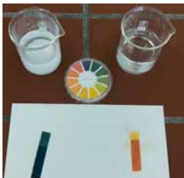
Slika 3: Določanje pH-vrednosti raztopinam z univerzalnim indikatorskim papirjem
